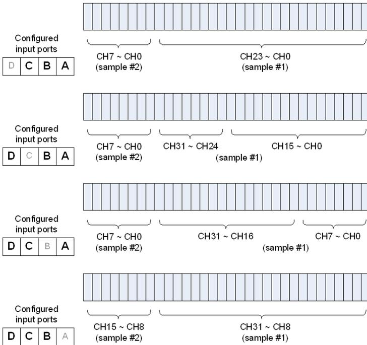
**Figure 3-4: DI raw data Mapping for 24-Bit Data Width**
