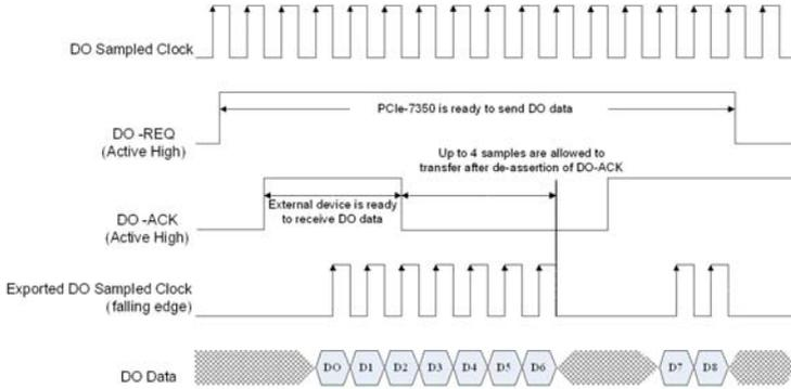
**Figure 3-21: DO Burst Handshake Timing Diagram**
